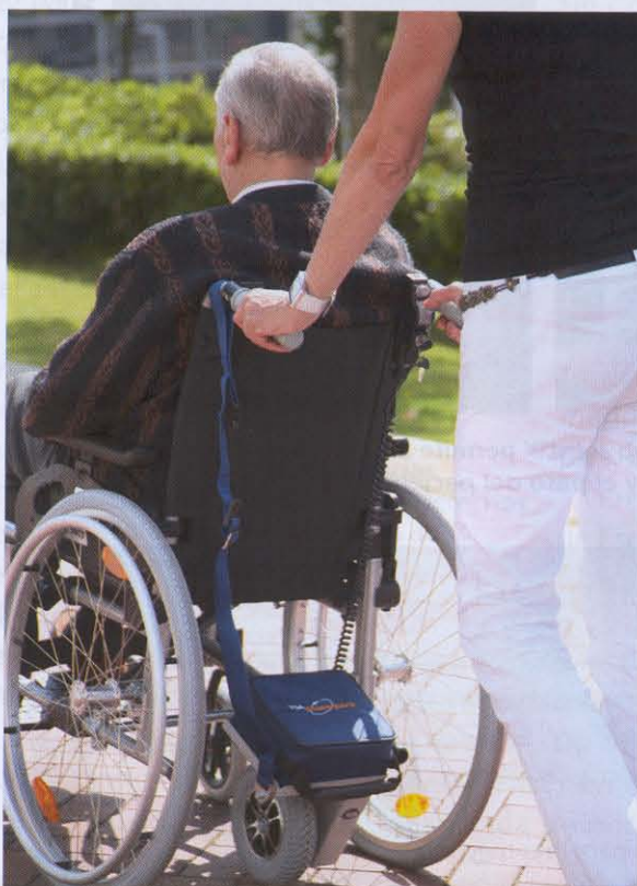
El TGA permite al acompañante regular la velocidad desde las asas
